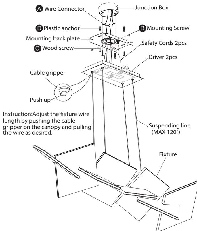
**Fig. 2 Wiring**
